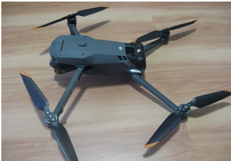
hőkamerával felszerelt felmérő drón
